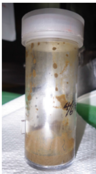
4/6サンプリング結果 (上澄み液除去後) 表面線量… \gamma : 6mSv/h \beta+\gamma : 15mSv/h
