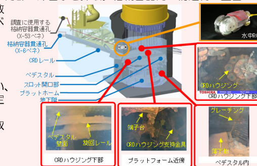
ペDESTAL内部の状況
