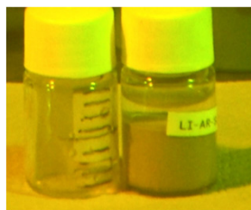
静置によりスラッジが沈降し、上澄みの層が現れる。
