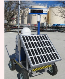
線量率モニタの設置状況
