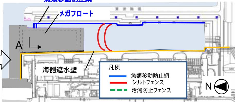
工事期間中は、海底土の舞上りに配慮するため汚濁防止フェンスを設置するとともに、構内排水路からの放射性物質の拡散防止のためシルトフェンスは引き続き設置する。
