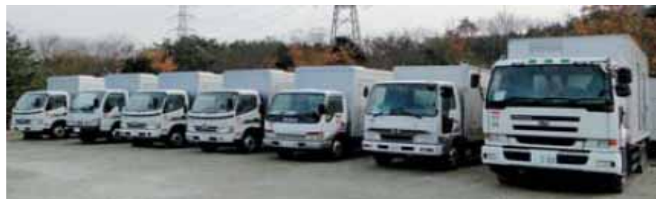
電源車(500~750kVA 14台, このほかにガスタービン車 4500kVA 2台)
