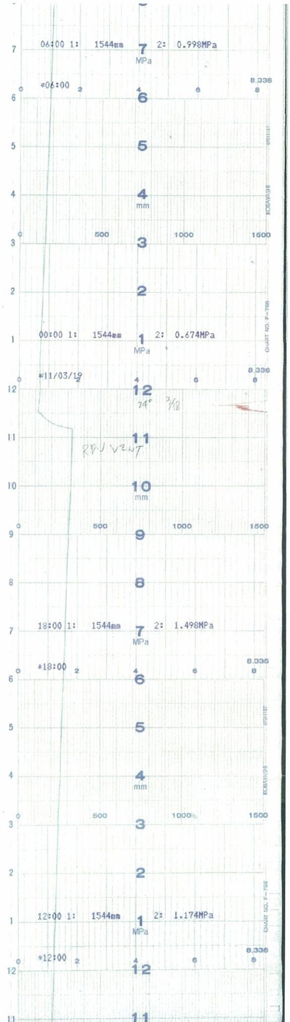
5号機 原子炉压力/原子炉水位 (12 / 14)
