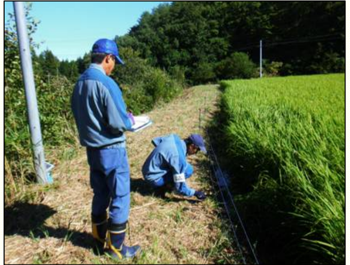
電気柵の電圧測定【平成25年9月17日】
