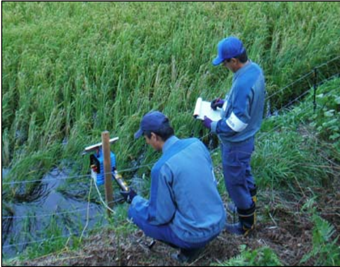
電気柵の電圧測定【平成25年9月17日】
