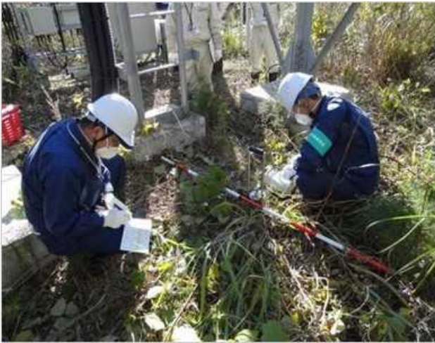
【現場調査状況(地表面の汚染密度の測定)】
