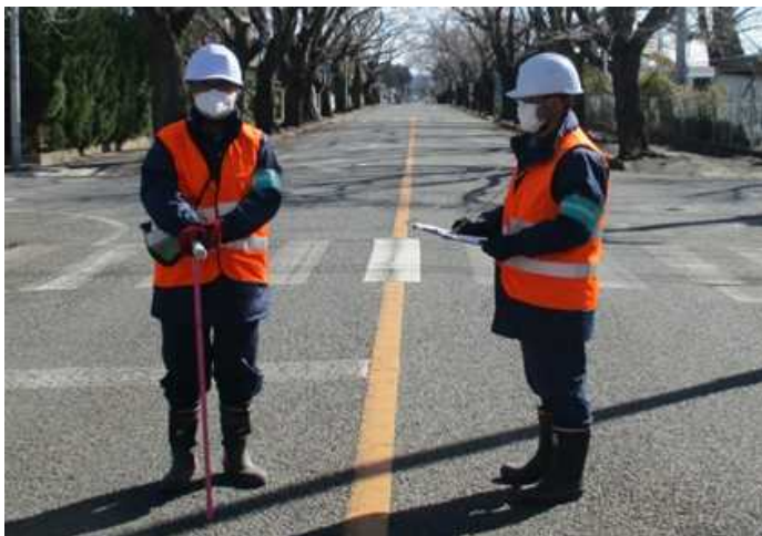
本格除染後の線量確認状況 (1)
