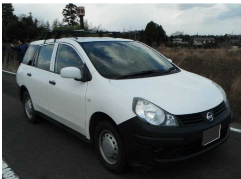
車両による走行モニタリング状況
