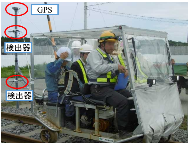
【線路上モニタリング状況】
