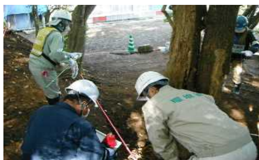
【川俣町モニタリング状況】 （除染中の線量確認状況）
