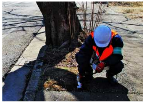
【本格除染後の線量確認状況(2)】
