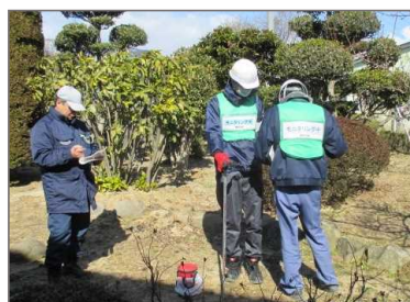
除染作業後の モニタリング
