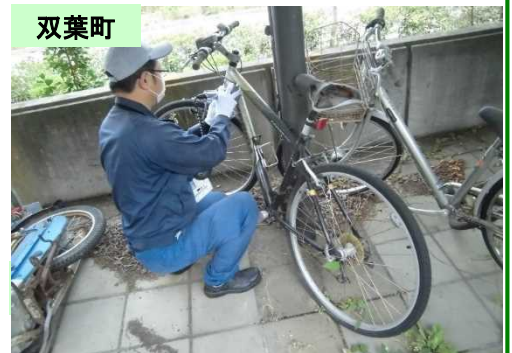
【③残置物の表面汚染密度測定】
