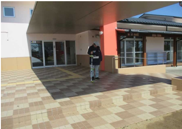
玄関前での空間線量率測定状況
