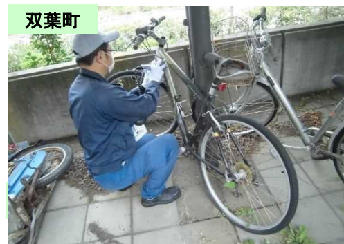
【③残置物の表面汚染密度測定】
