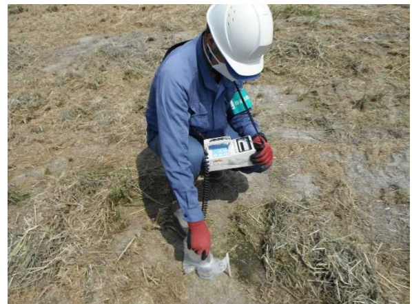
【表面汚染密度の測定状況】
