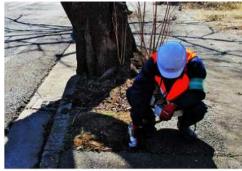
【本格除染後の線量確認状況(2)】
