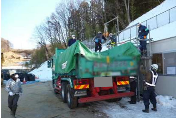
【荷台遮水対策の実施状況確認】
