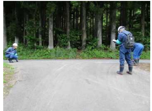
【輸送ルートの幅員測定状況】
