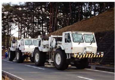
陸上での起振車による地下探査
