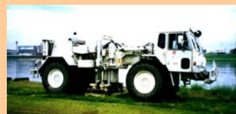
起震車A（バイブレーター） （探査深度 2 km程度）
