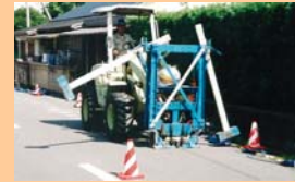
起震車C（板たたき装置） （探査深度 30m程度）
