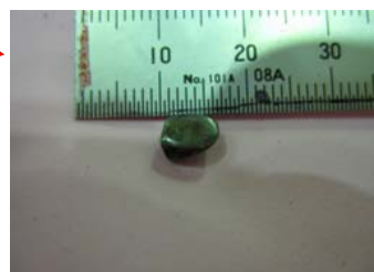
粒状の金属片 (約6mm × 約5mm × 約3mm)
