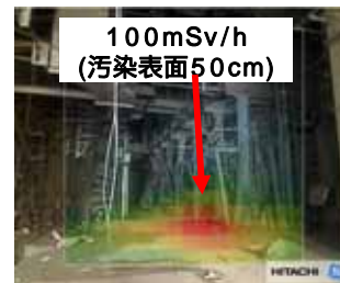
ガンマカメラによる大物搬入口付近撮影(H24/6/11～15)
