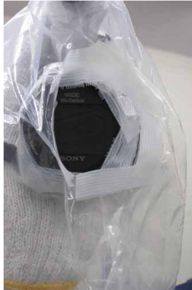
写真 外側養生テープ剥がれ
