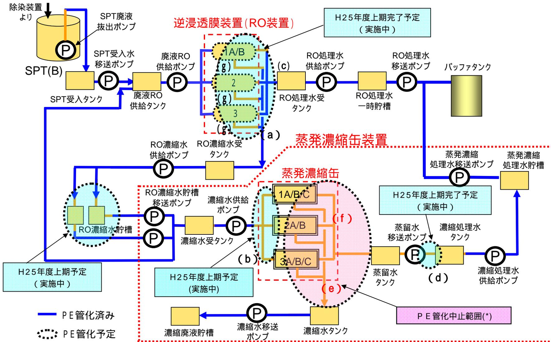
(\*) 蒸発濃縮装置から濃縮水タンク、蒸留水タンクまでの移送ラインは、過去の漏えいが発生した耐圧ホースと構造が異なり、ホースが抜けない構造となっていること等の理由によりPE管化の計画を中止。
