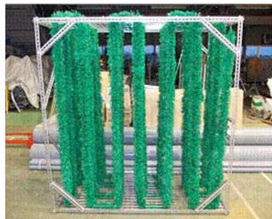
繊維状吸着材浄化装置
