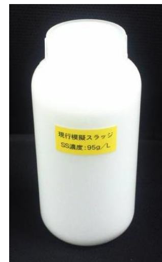
調整した試験用 模擬炭酸塩スラリー
