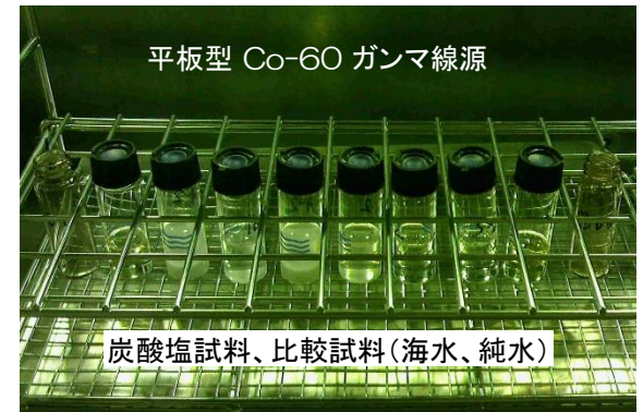
炭酸塩試料のガンマ線照射の様子
