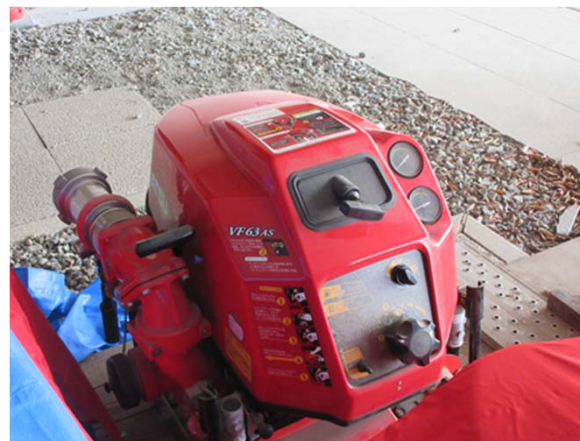
可搬式消防ポンプ （炉注用のポンプとして、 港湾（物揚場）にて使用）
