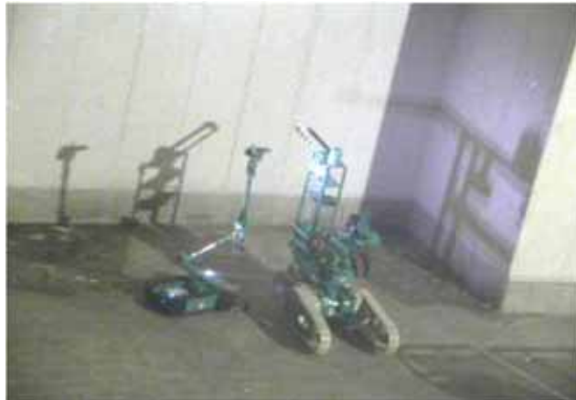
① 遠隔無人ロボット測定状況(天井カメラ撮影)
