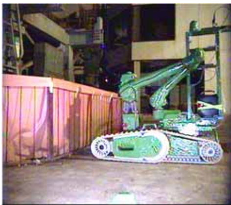
② 遠隔無人ロボット測定状況(ロボット撮影)
