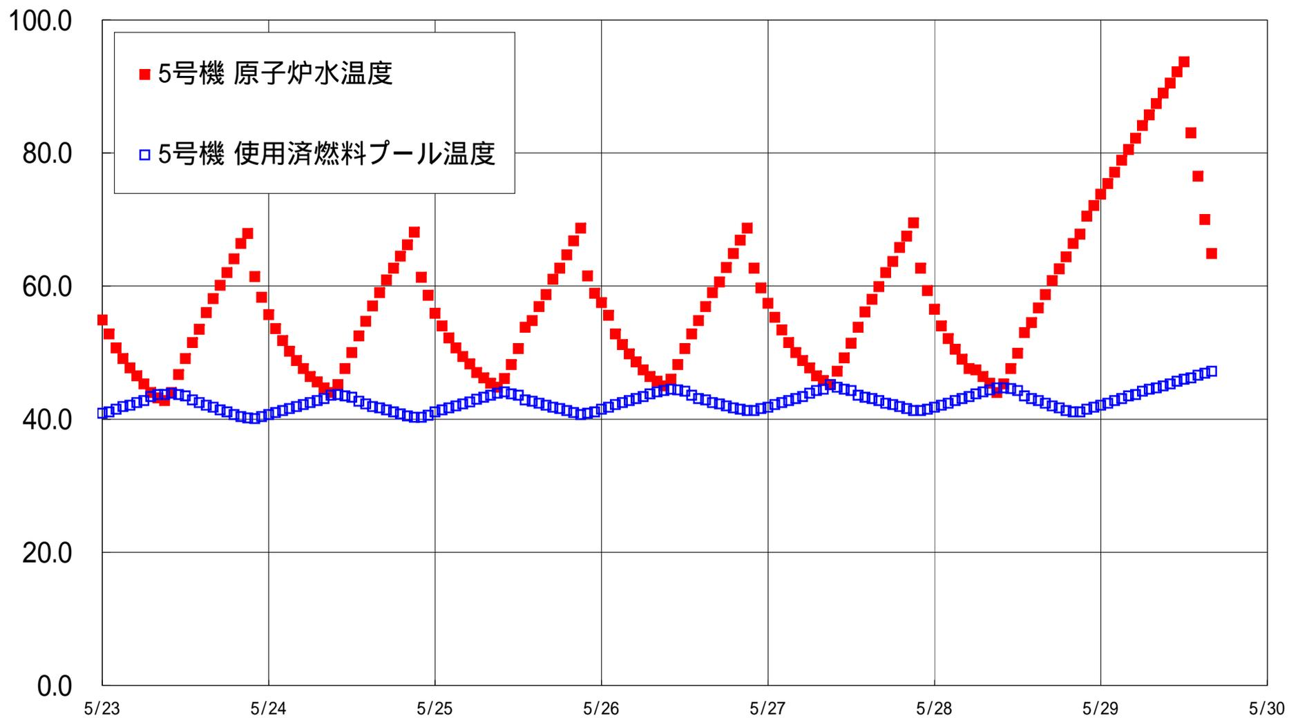
福島第一原子力発電所 5号機 原子炉水温度・使用済燃料プール温度
