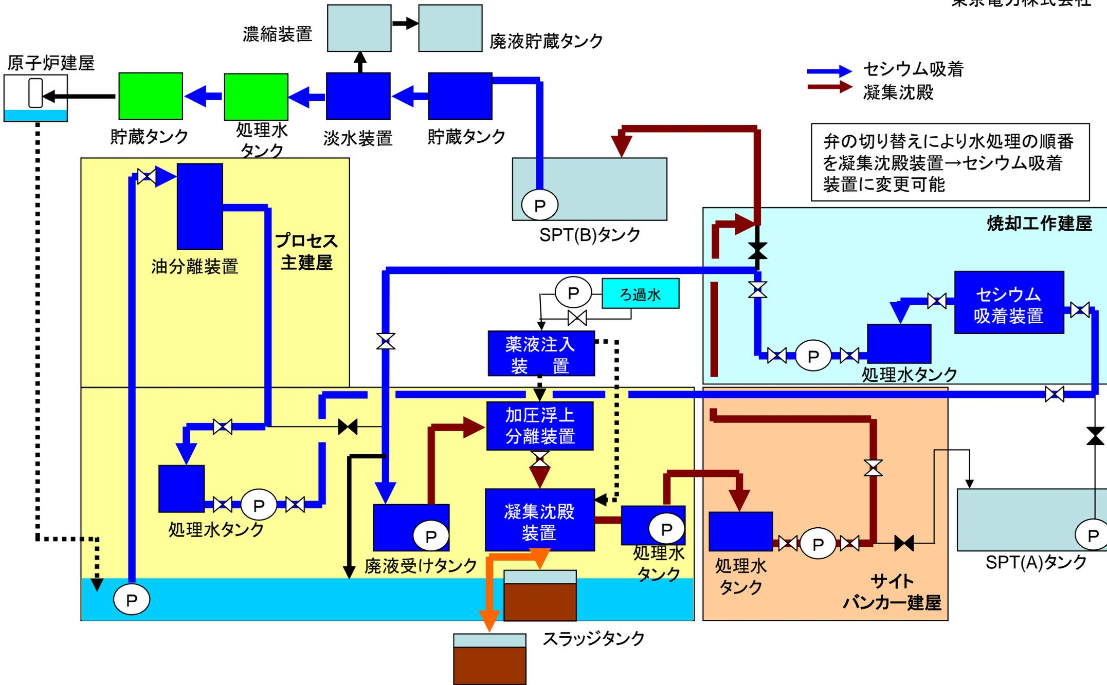
水の流れ: プロセス主建屋 → 油分離装置 → セシウム吸着装置 → 凝集沈殿装置 → 淡水装置
