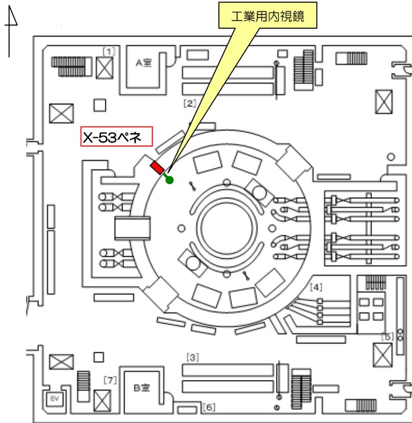
福島第一原子力発電所5号機原子炉建屋1階配置図
