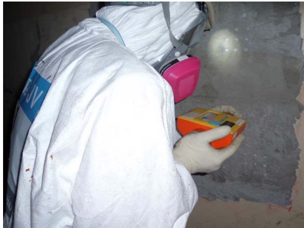
非破壊検査 (シュミットハンマー)
