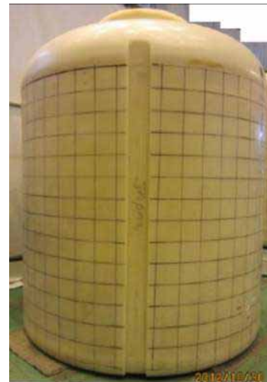
補強リング取り外し後
