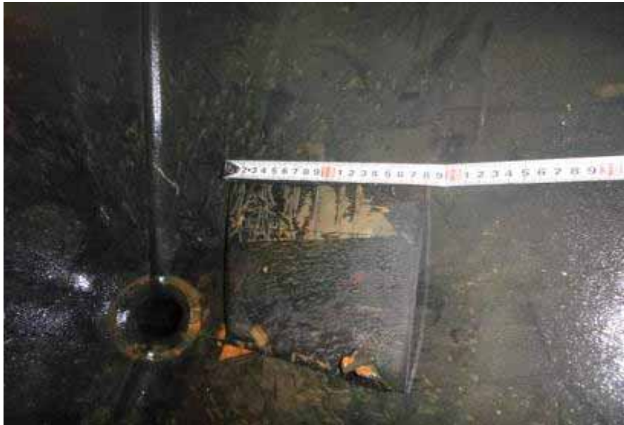
離脱した梯子用ゴムパッド (ドレン孔付近で発見)
