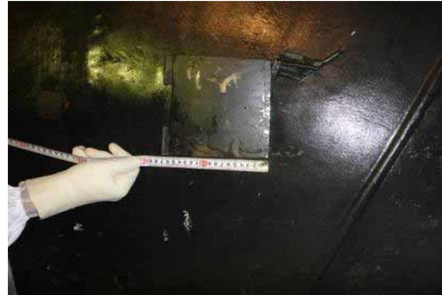
離脱せず当初の場所に残っていた 梯子用ゴムパッド (固定されていたテープを 取り外し、寸法測定を実施)
