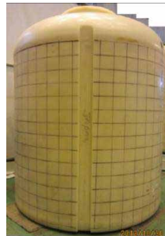
補強リング取り外し後
