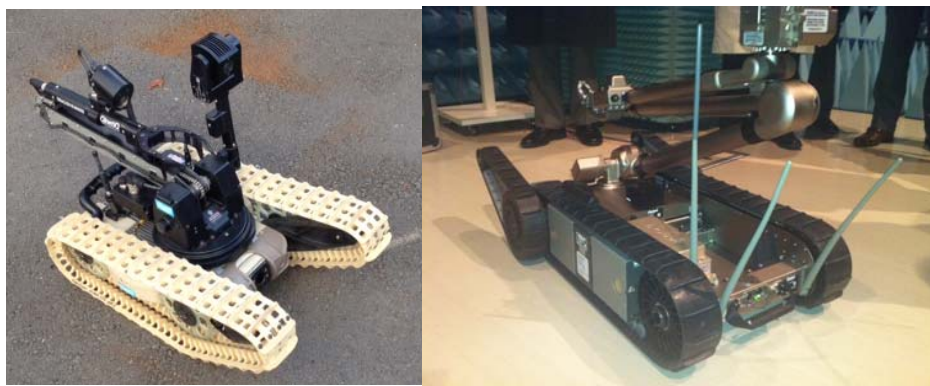
東電所有ロボット (線量率・線源・表面状態の調査に適用)
