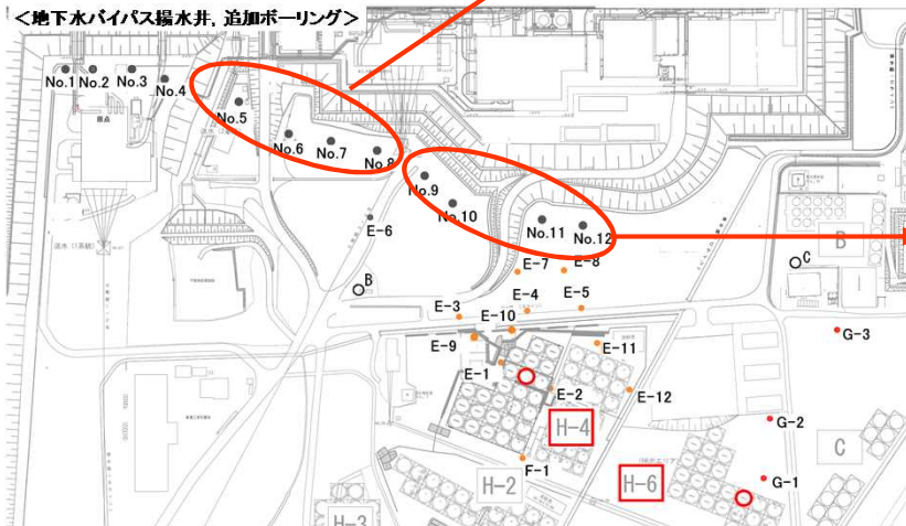
<地下水バイパス揚水井、追加ボーリング>
