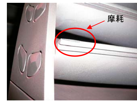
低圧タービン(A)動翼の摩耗
