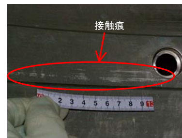
ジャーナル軸受の軽微な接触痕
