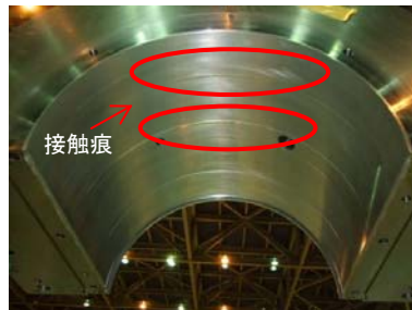
ジャーナル軸受の軽微な接触痕
