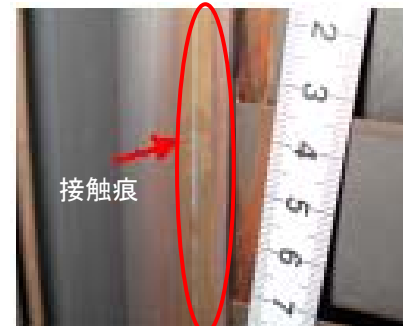
低圧タービン(C)静翼の接触痕
