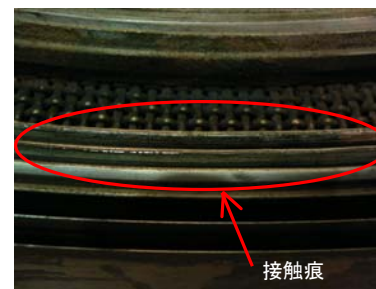
軸受油切りの軽微な接触痕
