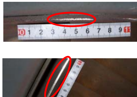
低圧タービン(A)静翼の接触痕
