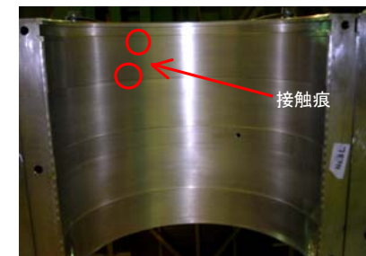
ジャーナル軸受の軽微な接触痕
