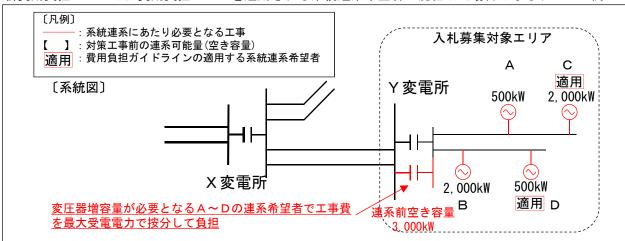
《A~Dが連系に必要な対策工事》 変圧器増容量工事費用 (10MW→15MW)
