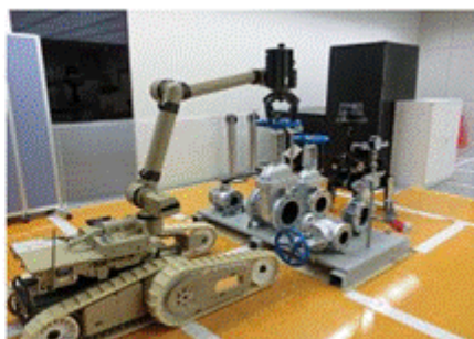
バルブの開閉操作
