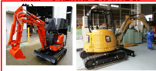
小型・大型無線重機 (屋外の瓦礫等の除去)
