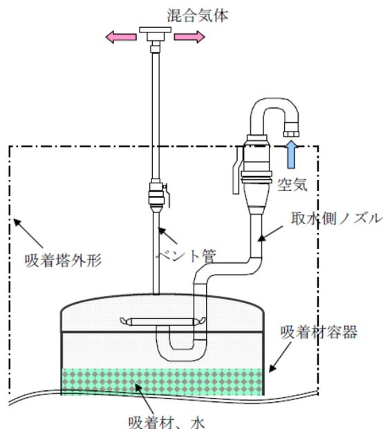
図1 使用済み吸着塔 保管時の概念図
