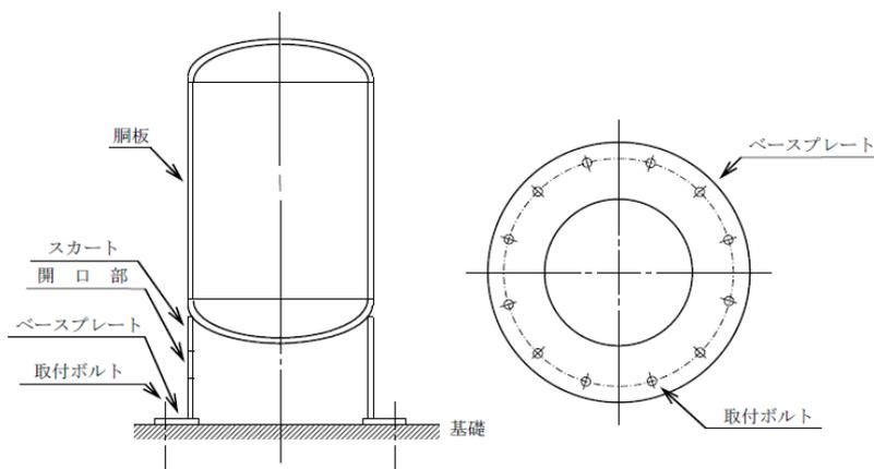
図-1 ろ過フィルタ・吸着塔概要図
