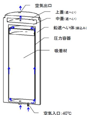
図1 吸着塔解析モデル (概念図)
