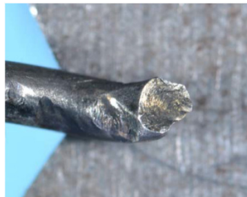
レーシングワイヤ破断面外観
