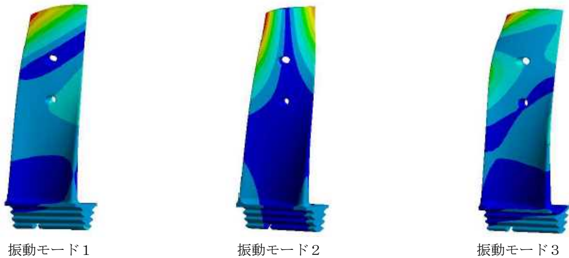
図－3 振動モード図（変形）
