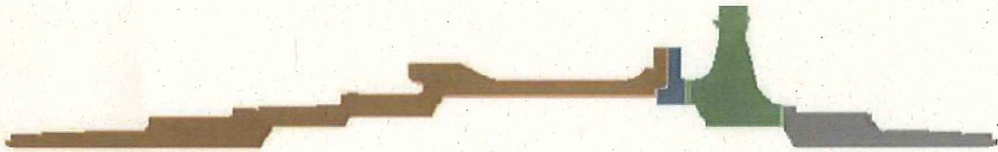
図－4 ロータシャフト固有値解析モデル
