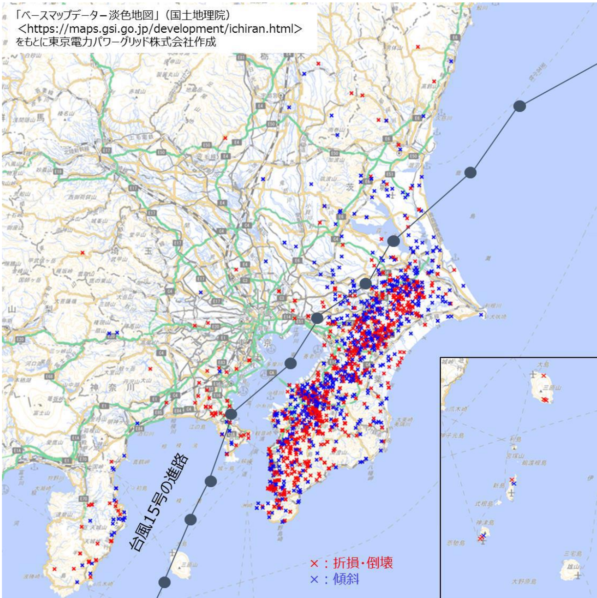
<台風 15 号の影響による電柱の被害発生状況分布図>
