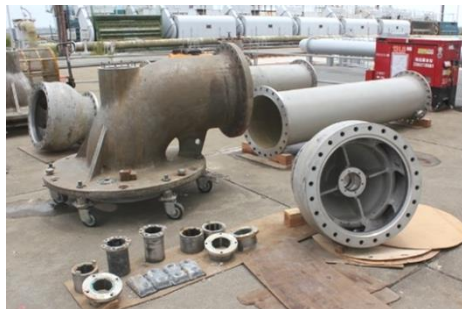
分解・点検・手入れをして、組み立てを待つポンプの部品
