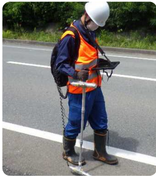
除染後の歩行モニタリング
