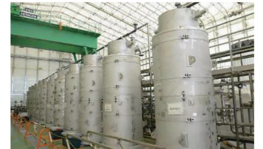
高性能多核種除去設備(吸着塔)
