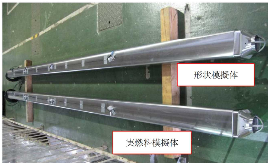
図－参考－４ 模擬燃料集合体の外観
