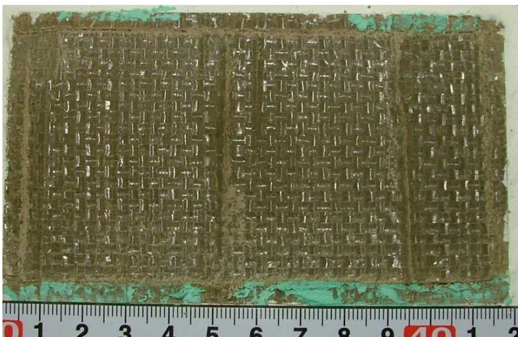
写真 3.4.6 スケール影響試験後の供試体状況 ケース 2-3 (西山モルタル表面)
