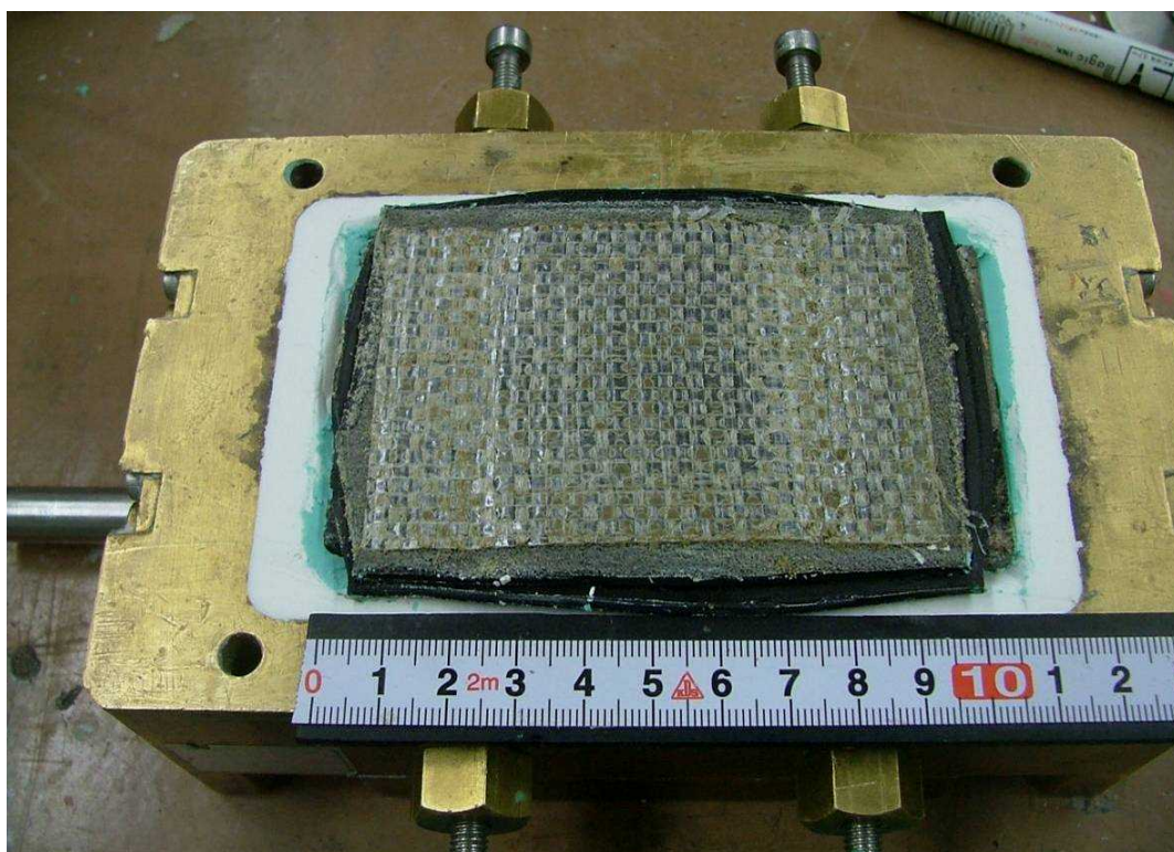
写真 3.3.15 繰返し載荷試験後の供試体状況 ケース 1-8 (保護層表面)
