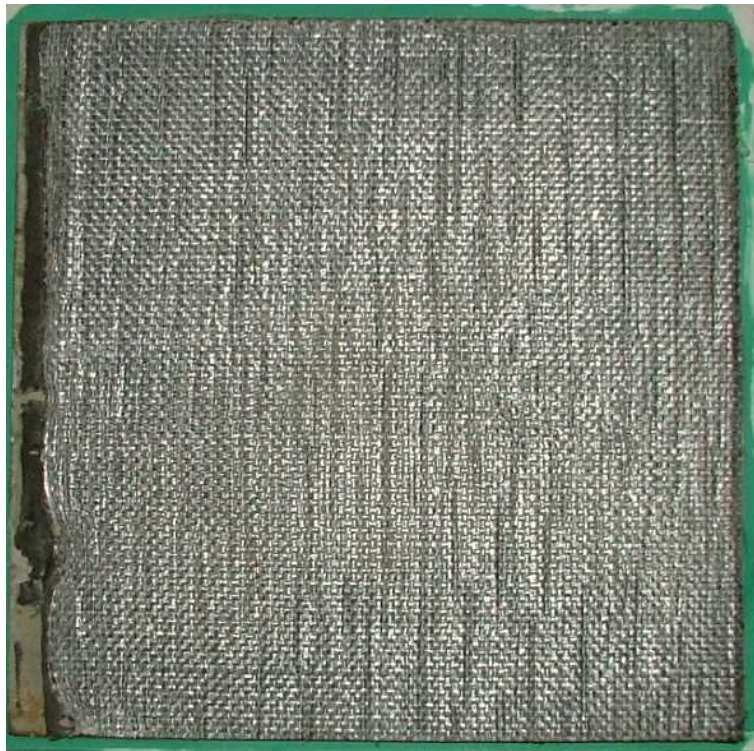
写真 3.4.7 スケール影響試験後の供試体状況 ケース 2・4（保護層表面）
