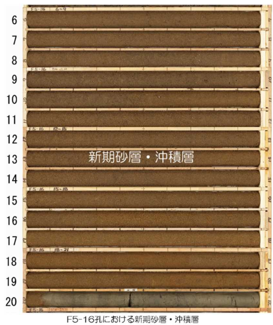
第 11-11-16 図 新期砂層・沖積層のコア写真 (F5-16 孔)
