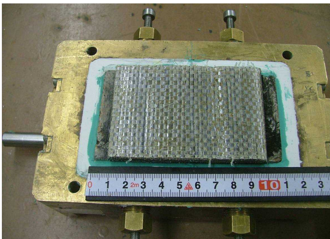
写真 3.3.9 繰返し載荷試験後の供試体状況 ケース 1-5（保護層表面）
