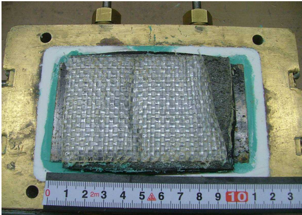
写真 3.3.7 一方向載荷試験後の供試体状況 ケース 1-4（保護層表面）
