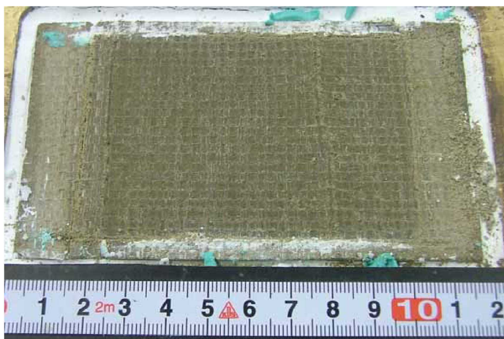
写真 3.3.4 一方向載荷試験後の供試体状況 ケース 1-2 (西山モルタル表面)
