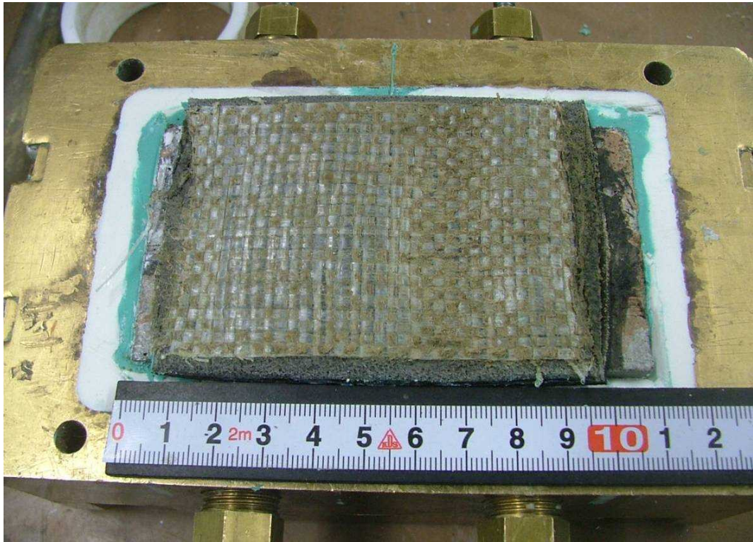
写真 3.3.13 繰返し載荷試験後の供試体状況 ケース 1-7 (保護層表面)
