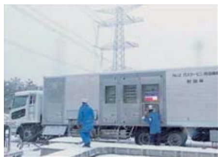
代替交流電源設備（ガスタービン発電機車、電源車）の接続訓練
