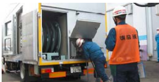
代替交流電源設備（ガスタービン発電機車、電源車）の接続訓練
