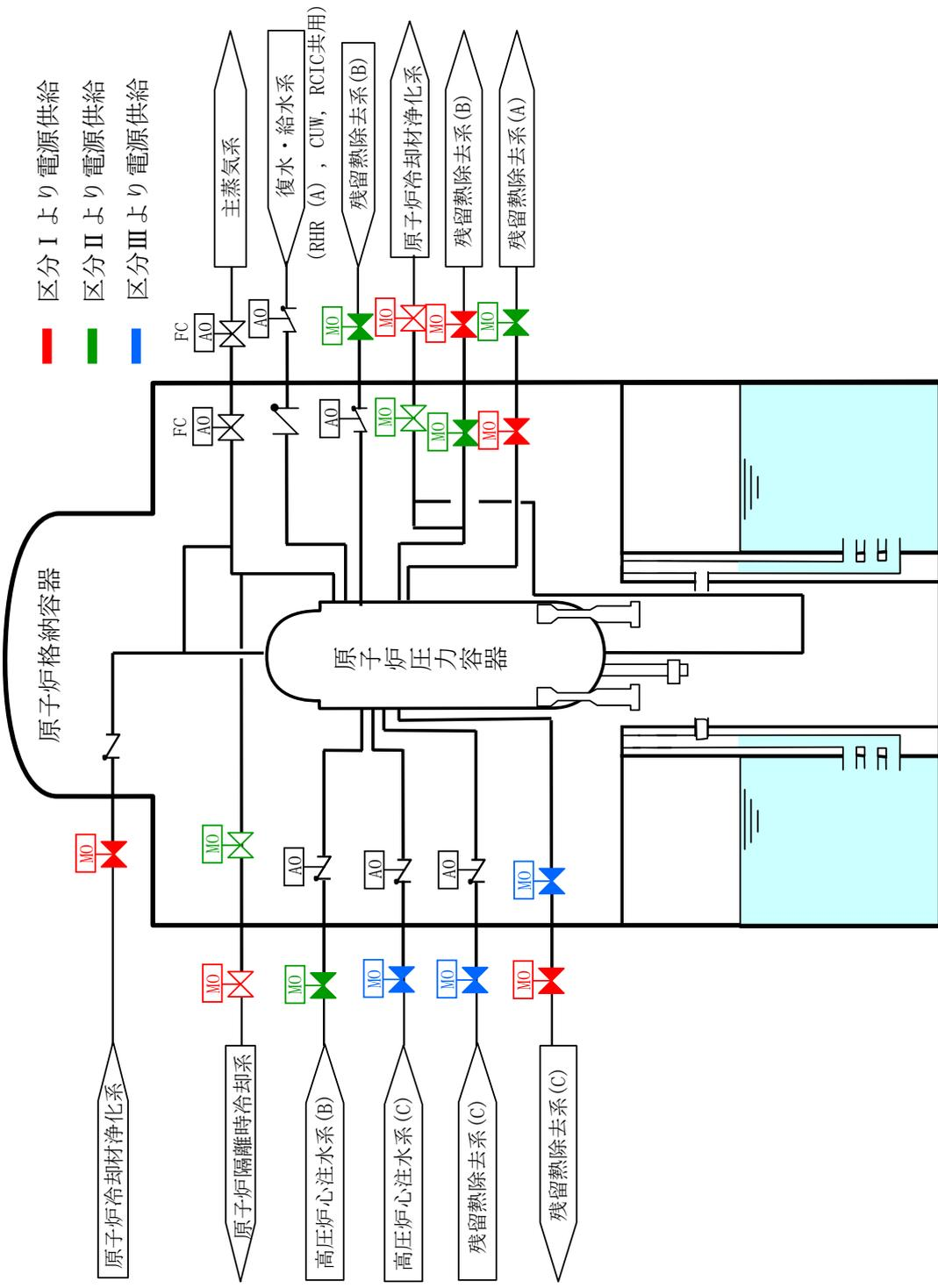
本図で示す原子炉压力容器バンドリ隔離弁は、「通常運転時の原子炉冷却材補給系によって通常停止等の安全上十分な措置がとれるまでの間、原子炉冷却材系への冷却水の補給が十分可能なほど破断時の流出流量が少ない小口径配管」のものについては省略している。また、通常時または事故時に開となるおそれがないものについても省略している。
