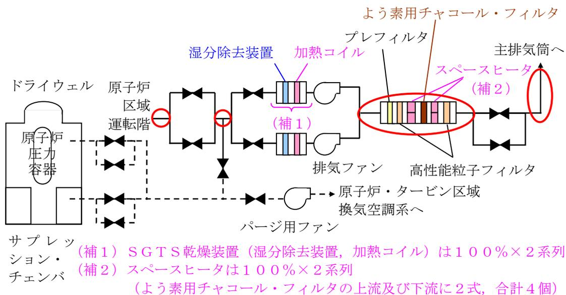
図1 非常用ガス処理系 系統概略図
