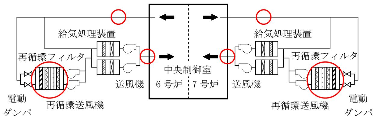
図7 中央制御室換気空調系 系統概略図
