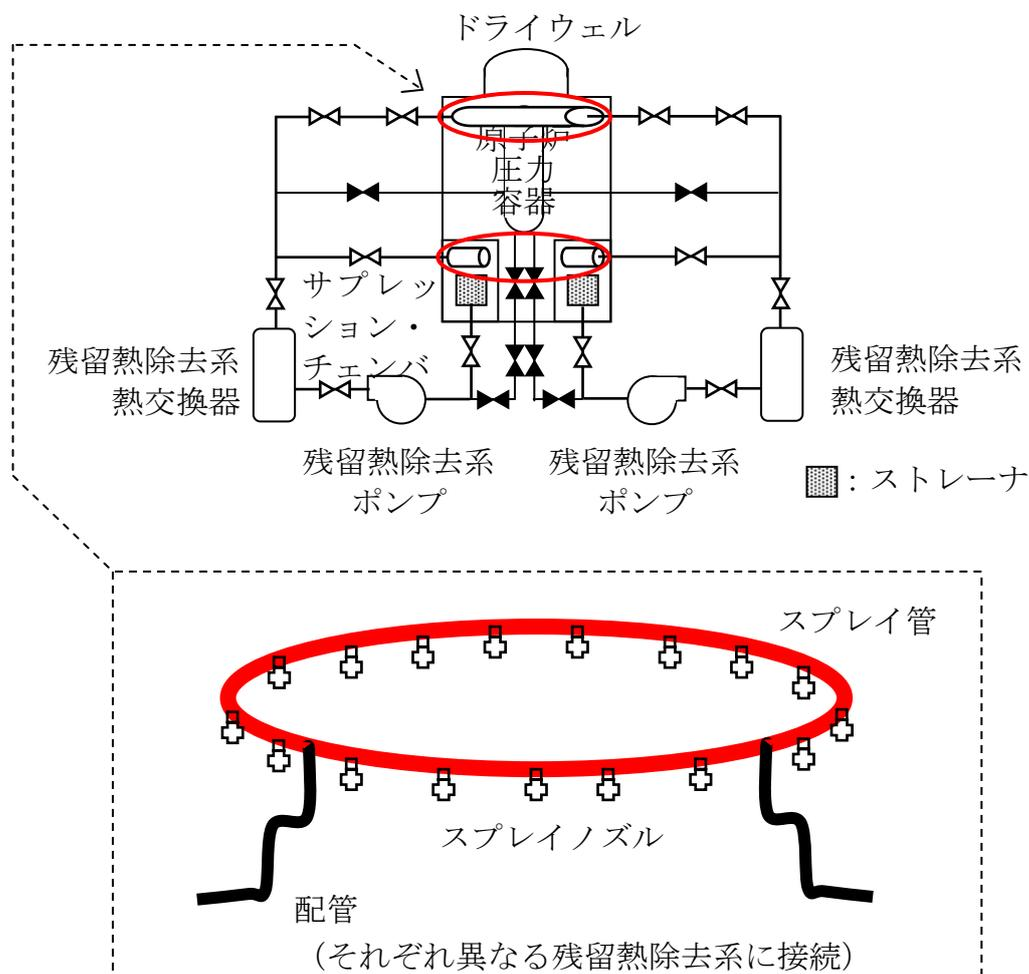
図3 格納容器スプレイ冷却系 系統概略図
