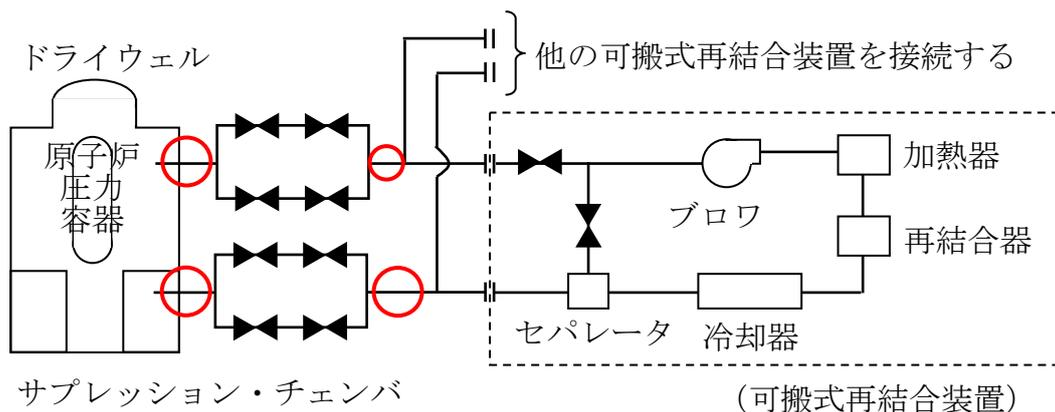
図6 可燃性ガス濃度制御系 系統概略図
