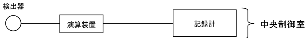
第 1-4 図 フィルタ装置水素濃度計の概略構成図
