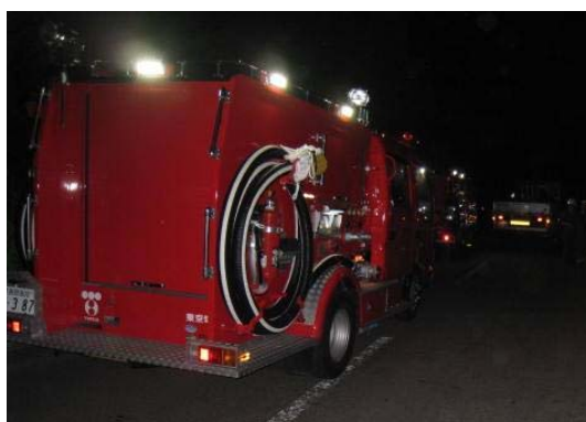
車両の作業用照明
